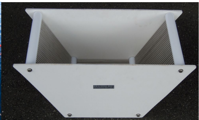
写真4 サイズ選別に用いた選別機
