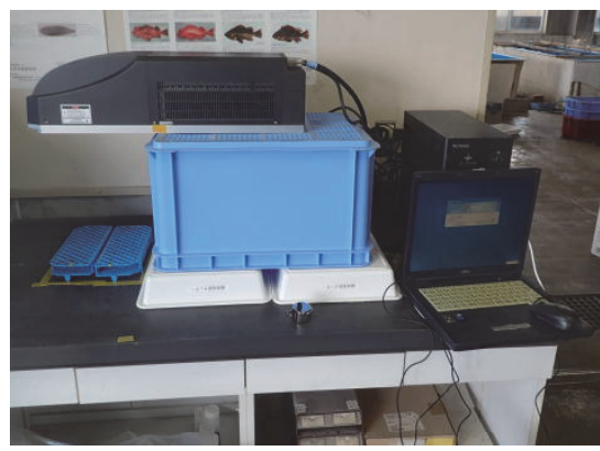
写真4 標識付機器「レーザーマーカ」
