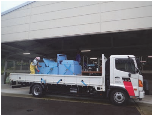
4 tトラック（断熱輸送水槽積載）
