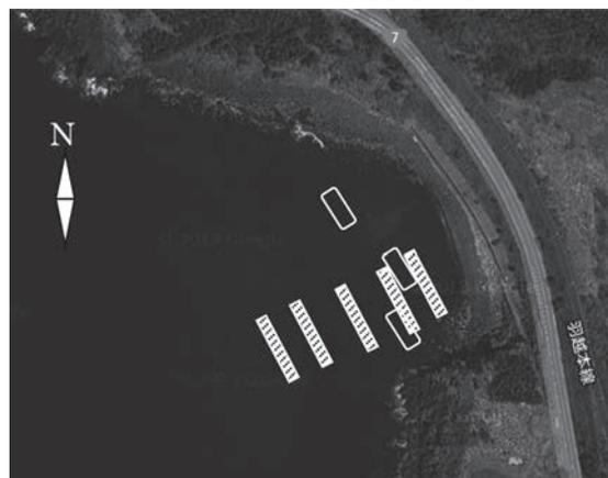
図-2 六脚ブロックが5列沈設されている（斜線四角枠）
