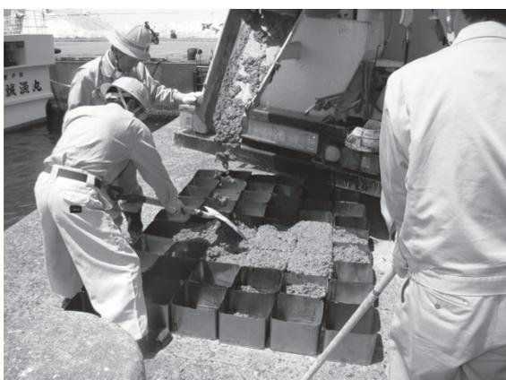
写真1 沈子の作製作業（5月13日）
