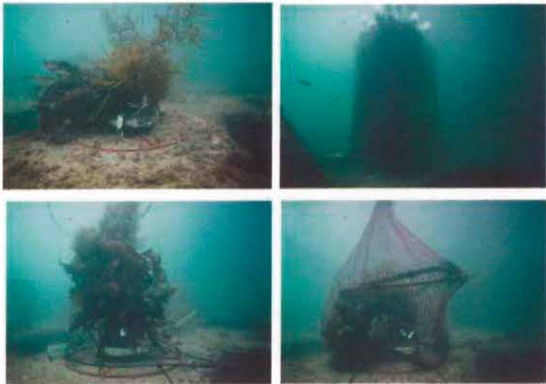
写真2 ①対照区（左上）、②人工海藻区（右上）、③テグス網区（左下）、 ④スパン網区（右下）
