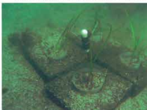
写真-7 アスファルト基盤区（地点A）2007.2 アスファルト表面にアマモが繁茂できる素材 が貼り付けてある。
